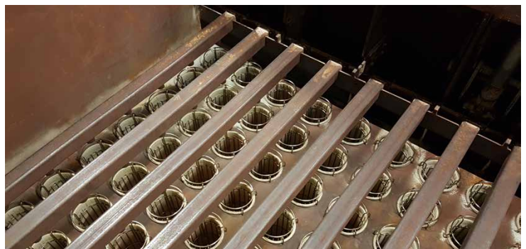
Filterschlauchreihen mit den dazugehörigen Abreinigungslanzen
