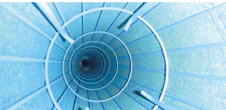
Innenseite eines Filterschlauchs nach erfolgter Reinigung
